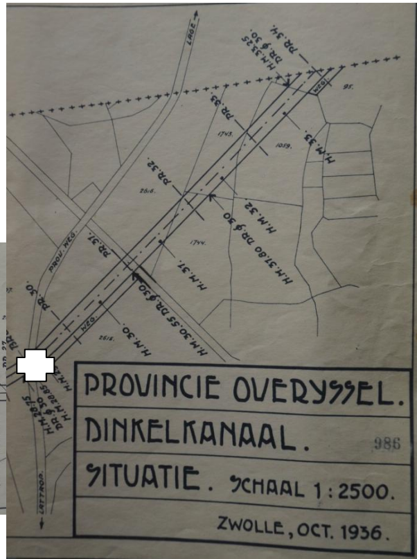
Figuur 4.5 Bestektekening van Dinkelkanaal met grondduiker (de pijl), bruggen (het kruis) en stuw (vierkant) (Waterschap Beneden-Dinkel, inv. nr. 246).
